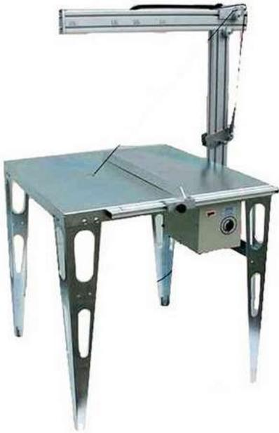
Стол для резки пенопластовых плит, пеноблока и др. изоляционных материалов. Вертикальная и угловая резка (под любым углом ) до 45°.
