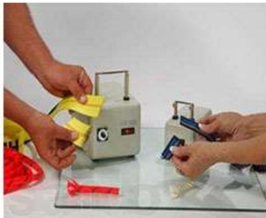
Прибор АМТ-00-VW, оснащён лезвием 88 мм = 60-миллиметровая рабочая зона и оснащён автоматическим переключателем температур (с темпр. готовности прибора в рабочую температуру), что существенно увеличивает КПД прибора.
