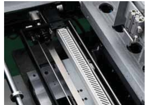
Naß-/Trockenreinigungssystem mit Absaugung durch Vakuum
