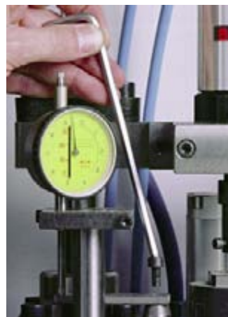
За счет сферической формы можно закручивать винты в тесных рабочих условиях.
