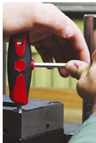
Работа превращается в удовольствие. Боковой привод прочно вставляется в винт и, стабилизируя рукоятку свободной рукой, прилагается больший крутящий момент.
