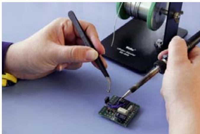
Пинцеты являются важными инструментами для каждого специалиста по электронике, обеспечивающими надежное выполнение необходимых работ часто в небольших и тесных структурах печатных плат.
