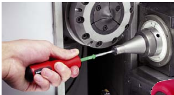
Быстро и надежно с помощью easyTorque – монтаж неперетачиваемых режущих пластин.
