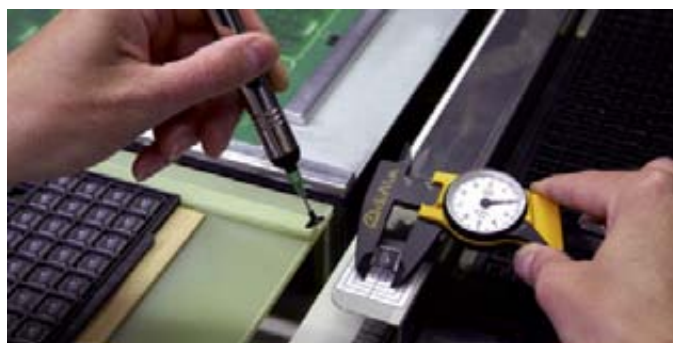
Штангенциркуль dialMax позволяет проводить измерения чувствительных электронных деталей.
