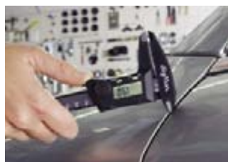
Измерительные губки армированных стекловолокном штангенциркулей позволяют проводить измерения на высокочувствительных, блестящих поверхностях без нанесения царапин.
