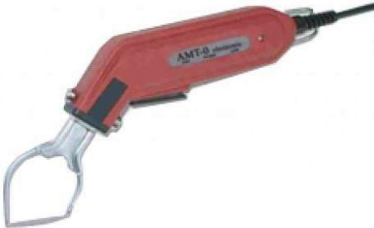
Ручной прибор горячей резки: высокой мощности, легкий, для кратковременной работы с применением в серийной терморезке в небольших количествах. Предназначен для разделения (отрезания, разрезания, ...) и одновременной спайки окончаний синтетических верёвок, шнуров, лент, ремней, а также краёв тканей. Время нагрева насадки термоножа от 6 до 8 секунд. Рабочая температура 600°C. Регулировка накаливания происходит через вкл. или выкл. включателя.
