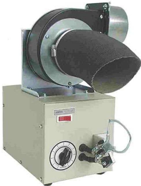
Прибор для непрерывной операции с твёрдо установленным термическим ножом (R-1 или G-90) а также бесступенчатым ручным регулятором рабочей температуры. Возникающие при работе пары могут быть удалены с помощью вытяжки (Type AMT-4-VW-mA).
