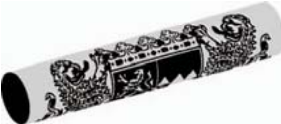
Komplexe Gravur mit "Ausspitzen" der Ecken, auf isel Maschine mit 4. Achse (Drehachse)
