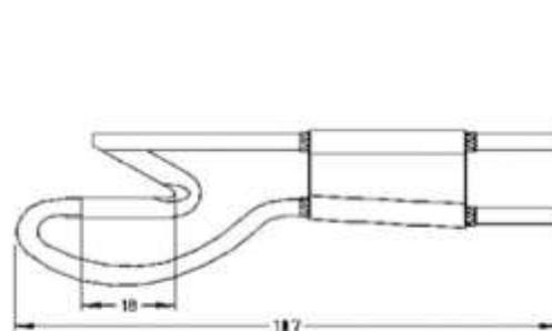
**Насадка: Тип N-2** Для вырезания канавок / пазов в изоляционных материалах. Для приборов: AMT-0, AMT-0E, AMT-0-electronic, AMT-1-VW, AMT-03-VW, A-3-VW.
