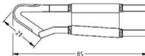
**Насадка: Тип G-90** Насадка для работы с материалом толщиной до 60мм. Для электр. приборов: AMT-3-VW, AMT-4-VW, AMT-4-VW-mA.
