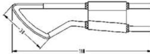
**Насадка: Тип F-2** Для приборов: AMT-0, AMT-0-electronic, AMT-1-VW, AMT-03-VW, AMT-3-VW.
