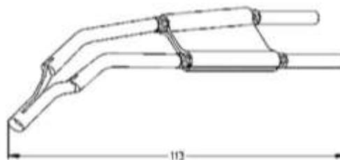
**Насадка: Тип RU 2** Тип RU 2 с  $\varnothing$  11-160 мм. Для электр. прибора: АМТ-3-VW.
