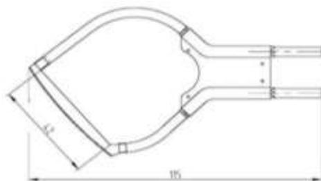
**Насадка: Тип AM-S** Насадку можно использовать для отрезания и одновременной запайки краёв/углов синтетических тканей (брезент, яхтовые паруса, шторы большой площади). Для приборов: AMT-0, AMT-1-VW, AMT-03-VW, AMT-3-VW.
