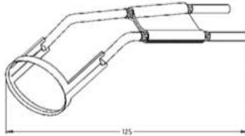
**Насадка: Тип WI** Для электр. прибора: АМТ-3-VW.
