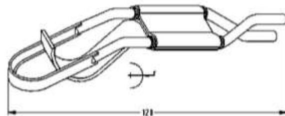
**Насадка: Тип R-50** Для приборов: AMT-0-electronic, AMT-1-VW, AMT-03-VW, A-3-VW, AMT-4-VW, AMT-4-VW-vA.
