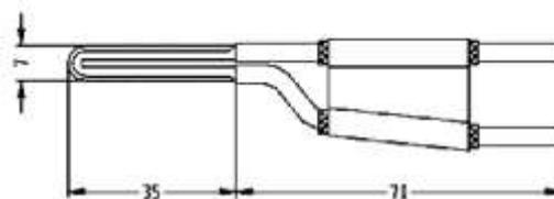
**Насадка: Тип R-1** Насадка для резки канатов толщиной до  $\varnothing$  50мм. Для электр. приборов: AMT-0-electronic, AMT-3-VW, AMT-4-VW, AMT-4-VW-mA.
