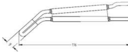
**Насадка: Тип С** Насадка для работы с жёстким пенопластом. Для приборов: АМТ-0, АМТ-1-VW, АМТ-03-VW, АМТ-3-VW.
