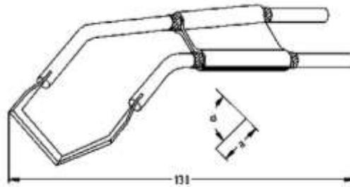
**Насадка: Тип V-Therm** Для электр. прибора: АМТ-3-Therm.
