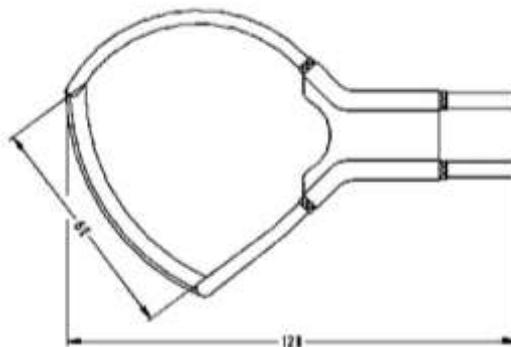
**Насадка: Тип V** Для приборов: AMT-0, AMT-1-VW, AMT-03-VW, AMT-3-VW.
