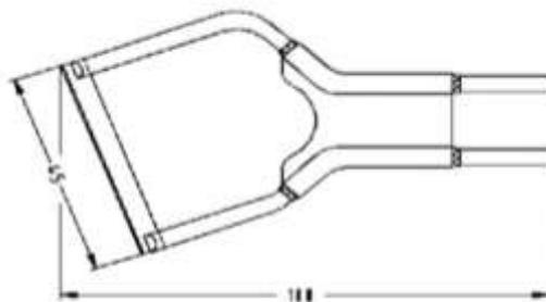
**Насадка: Тип F-3** Для электр. приборов: AMT-0, AMT-1-VW, AMT-03-VW, AMT-3-VW.
