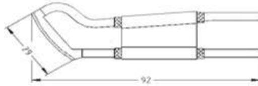
**Насадка: Тип HG** Для электр. приборов: АМТ-0, АМТ-1-VW, АМТ-03-VW, АМТ-3-VW.
