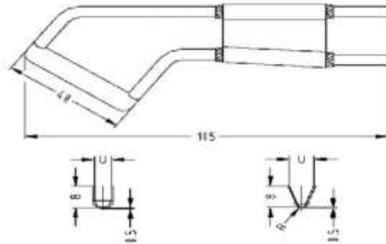
**Насадка: Тип F** Наконечник плавления для сваривания / спайки канатов и шнуров. Для электр. приборов: АМТ-0-electronic, АМТ-3-VW, АМТ-4-VW, АМТ-4-VW-mA.
