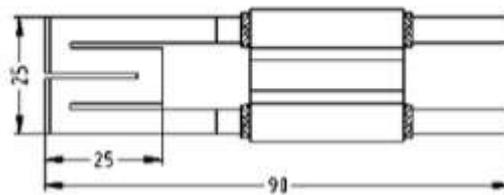
**Насадка: Тип RU** Тип RU с  $\varnothing$  3-10 мм. Для приборов: АМТ-0, АМТ-1-VW, АМТ-03-VW, АМТ-3-VW
