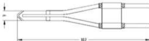
**Насадка: Тип R** Для электр. приборов: АМТ-0, АМТ-1-VW, АМТ-03-VW, АМТ-3-VW. Насадка высокой мощности для обработки материалов (верёвок, лент, ремней, поясов) толщиной до 15мм.
