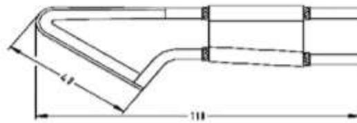
**Насадка: Тип N-1** Для вырезания канавок / пазов в изоляционных материалах. Приборы AMT-0, AMT-0E, AMT-0-electronic, AMT-1-VW, AMT-03-VW, A-3-VW.
