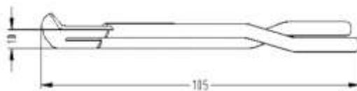
**Насадка: Тип АМТ-N** Для электр. приборов: АМТ-0, АМТ-1-VW, АМТ-03-VW, АМТ-3-VW. Специально для обработки нежных материалов или тонких верёвок, лент, ремней, поясов.
