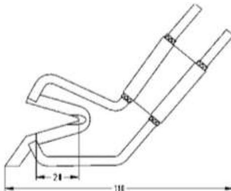
**Насадка: Тип AM-SG** Насадку можно использовать для отрезания и одновременной запайки краёв/углов синтетических тканей (брезент, яхтовые паруса, шторы большой площади). Для приборов: AMT-0, AMT-1-VW, AMT-03-VW, AMT-3-VW.
